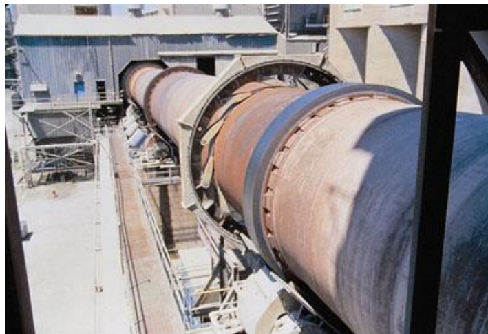
Figure 12 : Four responsable de la cuisson de la farine préchauffée
