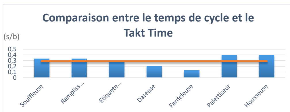
Figure 17 : Comparaison entre les temps de cycle des machines et le Takt time
