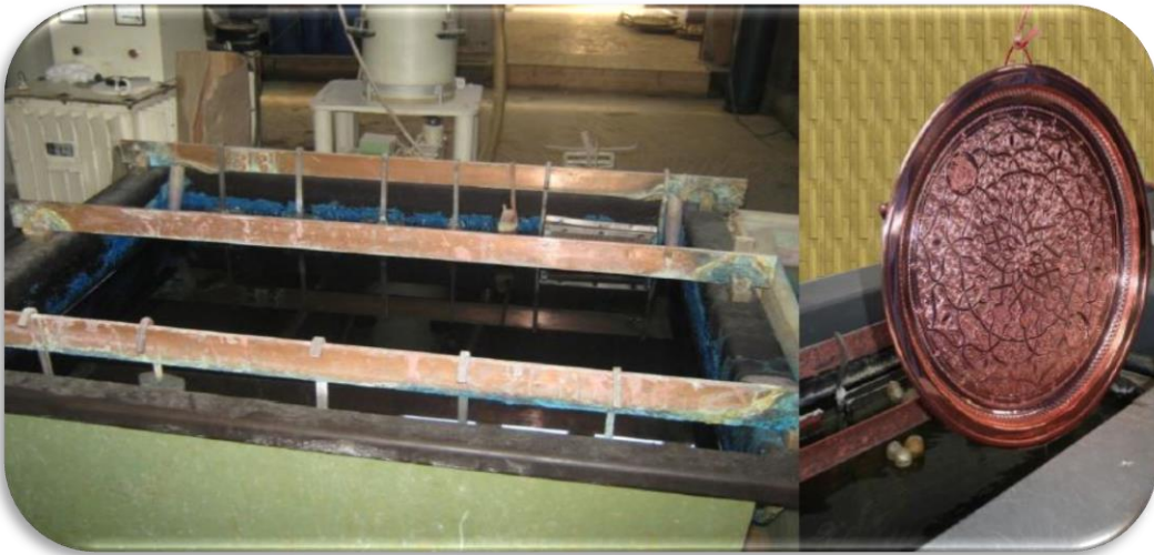
Figure 25 : Bain de cuivre acide et d'une pièce cuivrée
