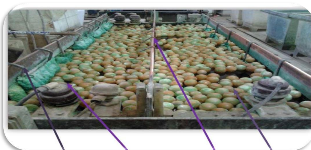
Plaque de nickel dans des sacs de termovyl Thermoplongeur Pièce a traité boule en plastique
