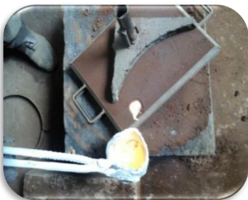
Figure 8 : Les moules d'un sable particulier Figure 9 : Four de fendage
