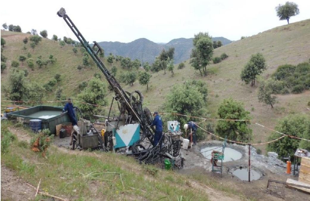
**Figure 13 : machine de sondage (Sondeuse LY44)**
