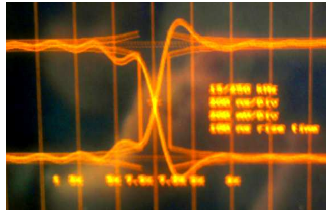
Figure 40: Mesure de la réponse transitoire d'un émetteur canal 5
