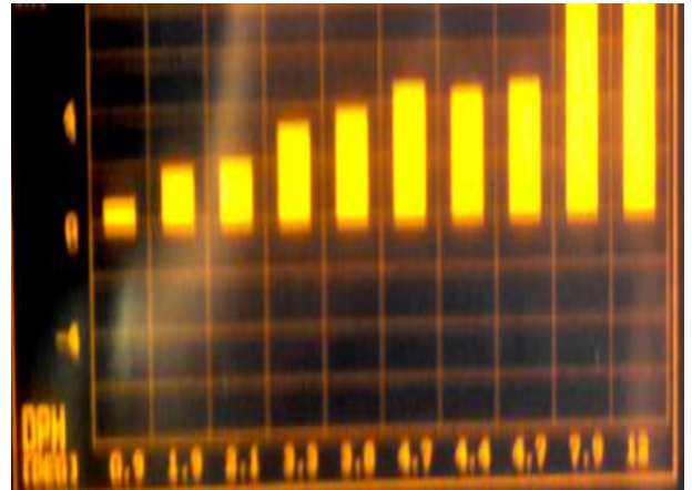
Figure 35: Mesure de phase différentielle d'une vidéo émet par un émetteur de canal 9.
