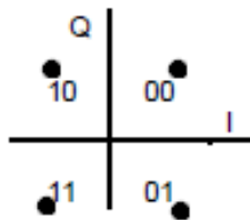
Figure 18: les symboles d'une modulation QPSK.
