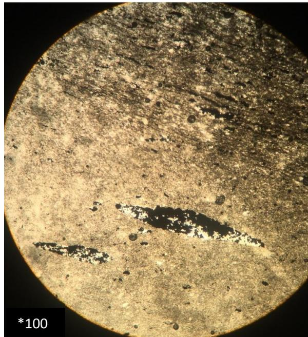
Photo 10 : observation microscopique d'une fente de tension à remplissage de sulfures (en LP et LN)
