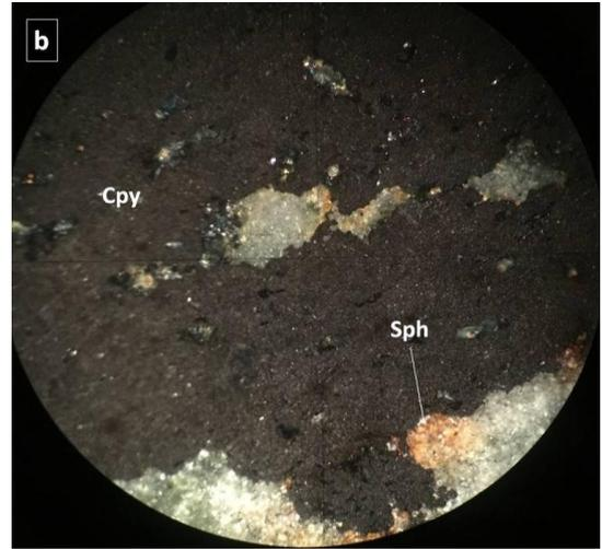
photo 36 : microphotographie en lumière réfléchie du minerai rubané montre la présence de la chalcopryrite et la sphalérite.
