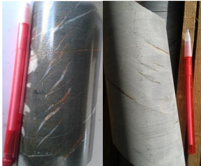
**Photo 9 : Les fentes de tension sigmoïdes à remplissage de quartz et du sulfures dans une carotte de sondage DS187.**
