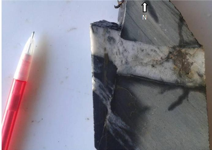
Figure 34 : une fracture remplie par du quartz décalée par une autre postérieure avec un jeu décrochant dextre.
