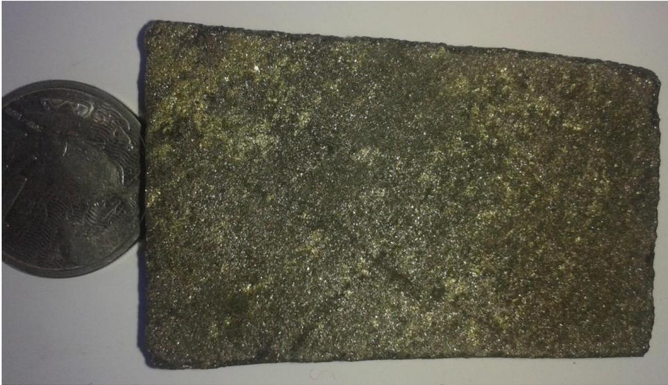
**photo 14: minéralisation massive traversée par le sondage carotté DS178 (chalcopryrite et pyrite dans la pyrrhotite massive**
