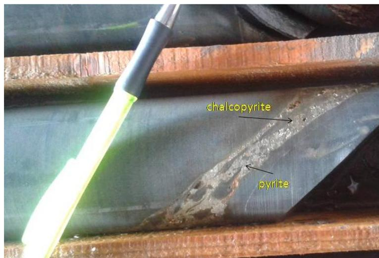
**Photo 17 : métapélites carbonatées à pyrite et chalcopirite**
