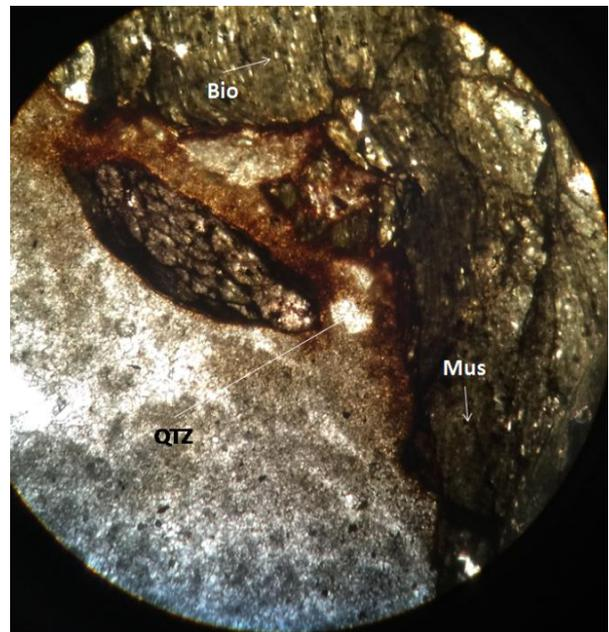
photo 31: microphotographie d'une chloritite en (LP) montre les micas (biotite et la muscovite) avec du quartz
