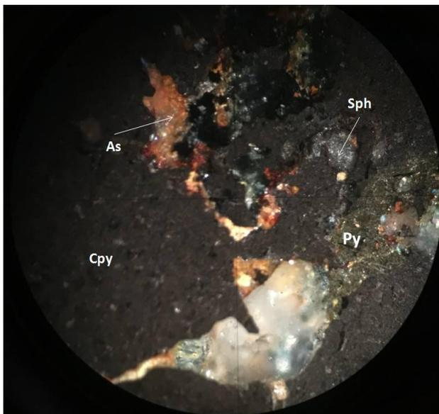
**photo 42 : microphotographie en lumière réfléchie du minerai en stockwork**
