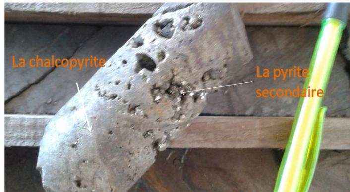
Photo 18 : la minéralisation massive à chalcopryrite et pyrite secondaire avec de la pyrrhotite.
