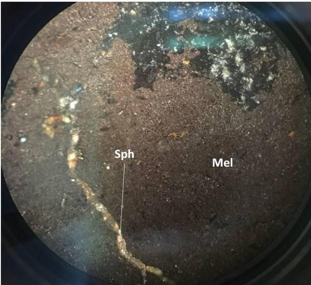
photo 32 : Vue au microscope métallographique en lumière réfléchie du minerai massif montre la dominance du Melnicovite avec la sphalérite.
