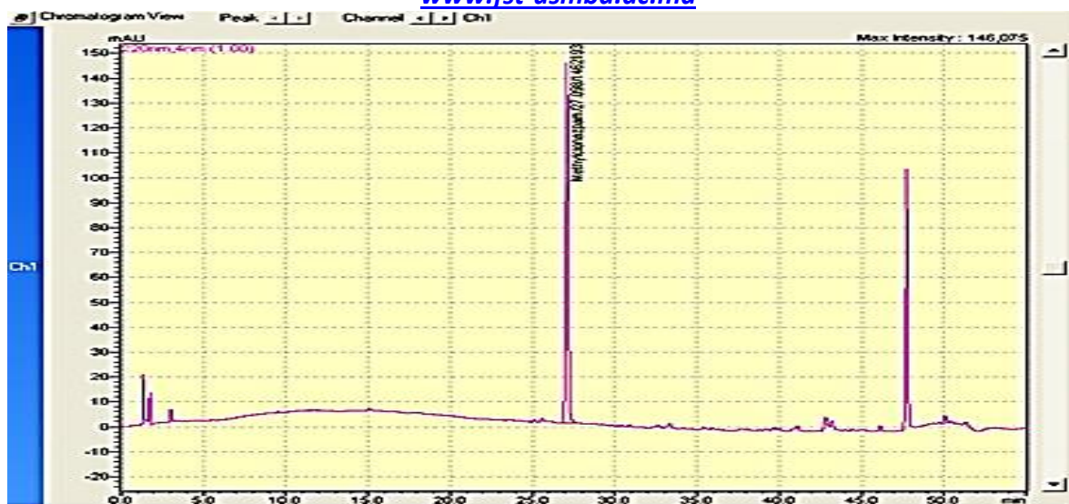
Figure 11 : Chromatogramme du dosage blanc (milieu biologique sans Bromazépam)
