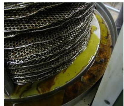
**Figure 7** - Déplacement latéral des huiles et des margines dans les scourtins<sup>[Wikipédia]</sup>.
