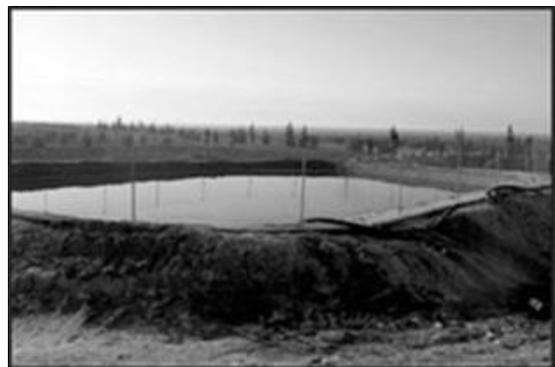
**Figure 14** - Séchage des grignons humides<sup>[14]</sup>.
