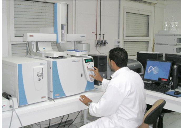
**Figure 18** - Appareil de couplage CG-SM
