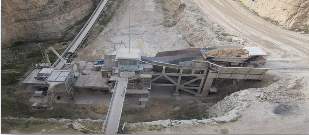
Figure 3:Extraction, transport et concassage de la matière
