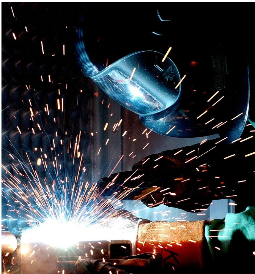
Figure 2.1 :Soudage à l'arc avec électrode fusible sous flux gazeux
