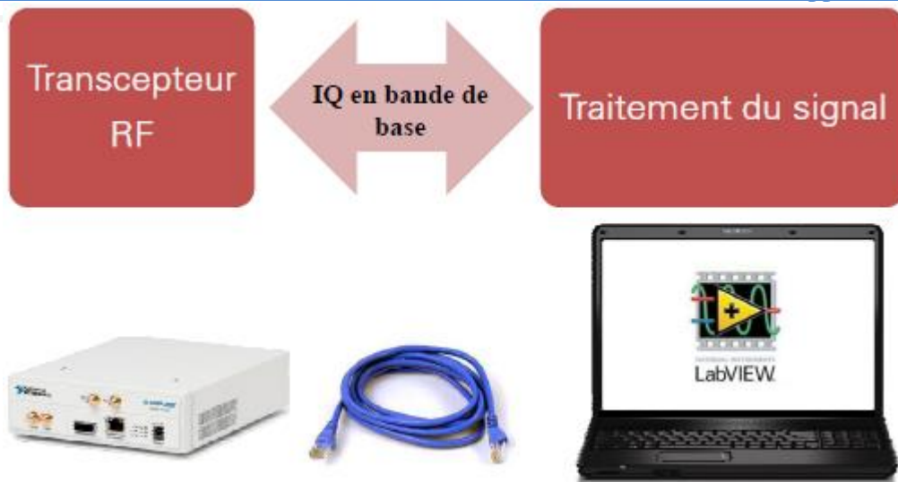
Fig.3.16 - Interfaces matérielles NI USRP avec le logiciel LabVIEW
