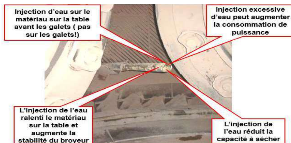
Figure 10 : Equipement d'injection d'eau dans le broyeur
