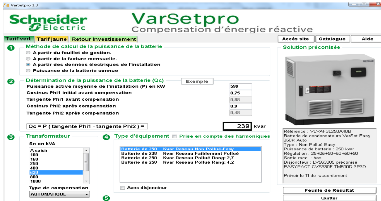
Figure 40: résultats des caractéristiques du compensateur du PTF
