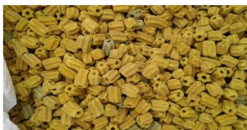
**Figure 9** : Le vanadium utilisé dans le convertisseur
