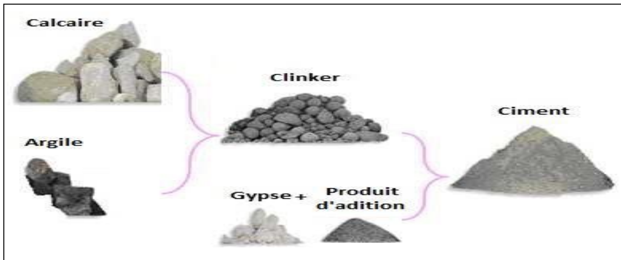
Figure 5 : les ingrédients du ciment
