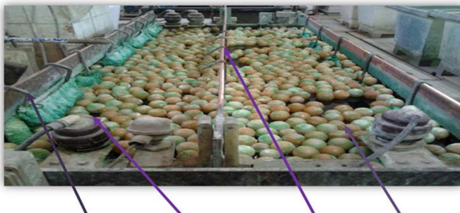
Plaque de nickel dans Thermoplongeur Pièce a traité poule en plastique Des sacs de termovyl
