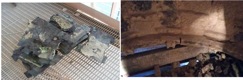
Figure 17: Chute prématurée des tubes plongeurs des cyclones inférieurs
