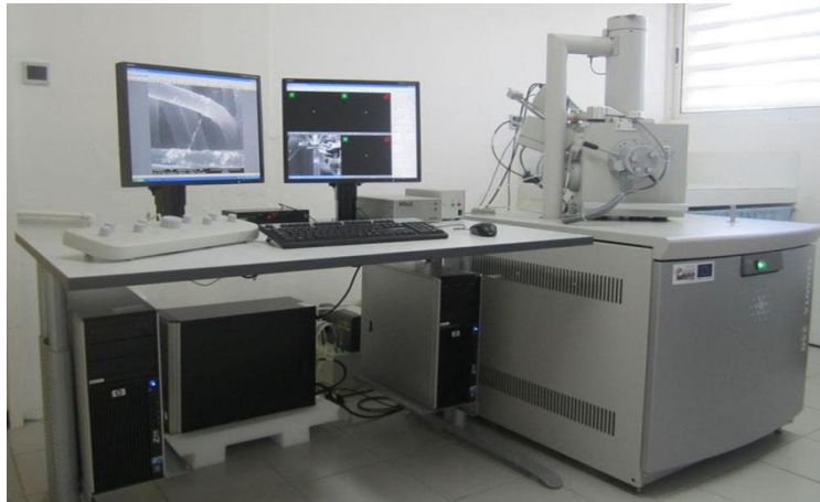
Figure 20 : Image de l'appareil de microscopie électronique à balayage « Quanta 200 FEL équipé de sonde EDAX »
