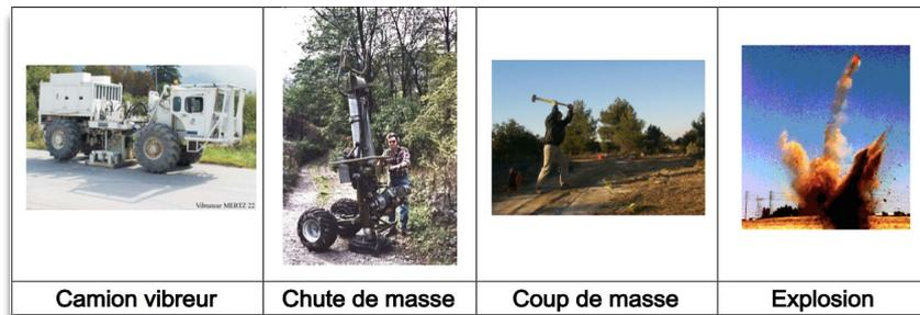
Figure 39 : différentes sources d'ébranlement
