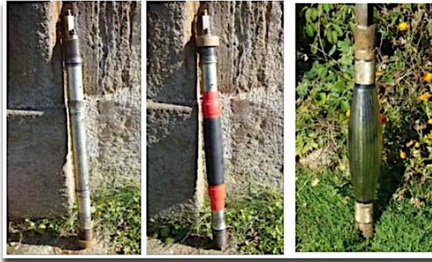
**Figure 28 : La sonde se compose de trois parties: (1) corps de la sonde métallique avec orifices d'injection d'eau et gaz; (2) La membrane en caoutchouc de la cellule de mesures;(3) la gaine de protection à lamelle métallique.**
