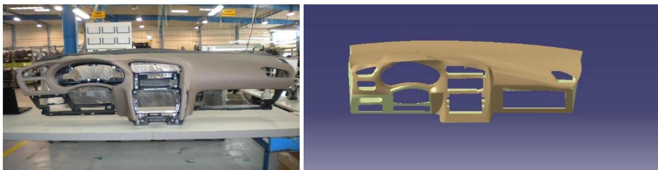
Figure : Comparaison entre le produit fini et le produit conçu sur CATIA
