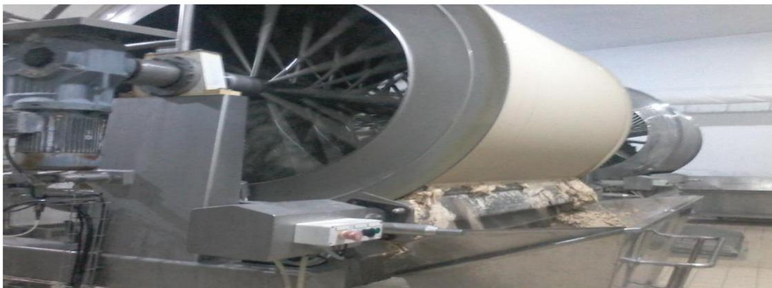
**Figure 7 : Filtre rotatif**
