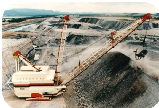
Fig.6 : décapage par dragline
