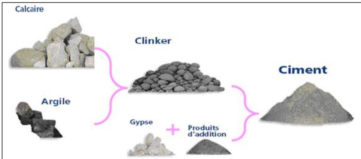
**Figure 1 : les composés nécessaires pour la production du ciment**
