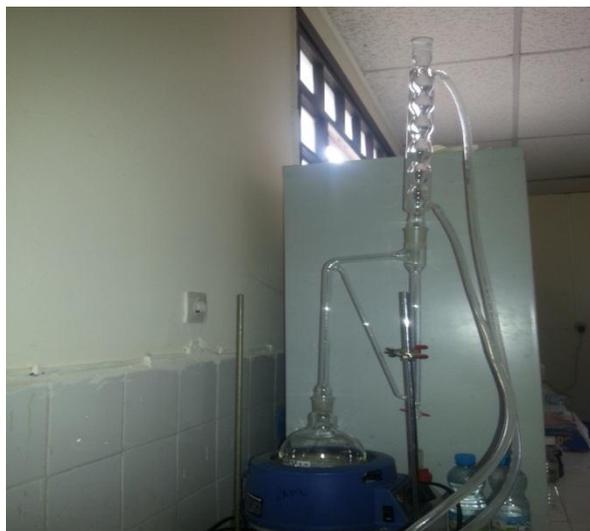
*Photo 5 : L'appareillage de l'hydrodistillation*
