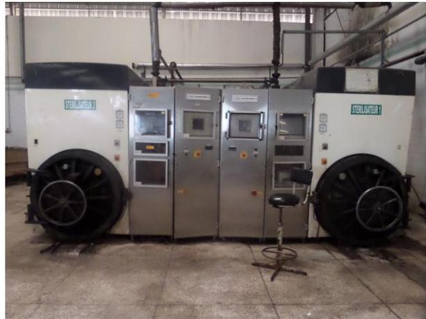
*Figure 6 : Machine du traitement thermique*
