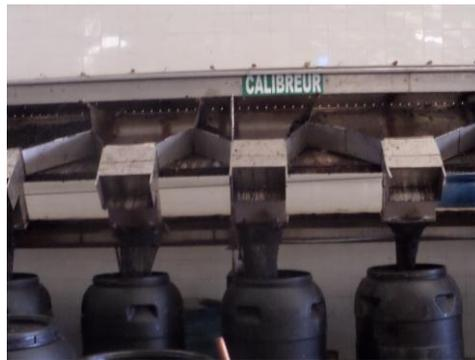
*Figure 5 : Machine de calibration*
