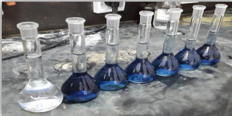
Figure 4: Complexe bleu phosphomolyb-2-molybdique
