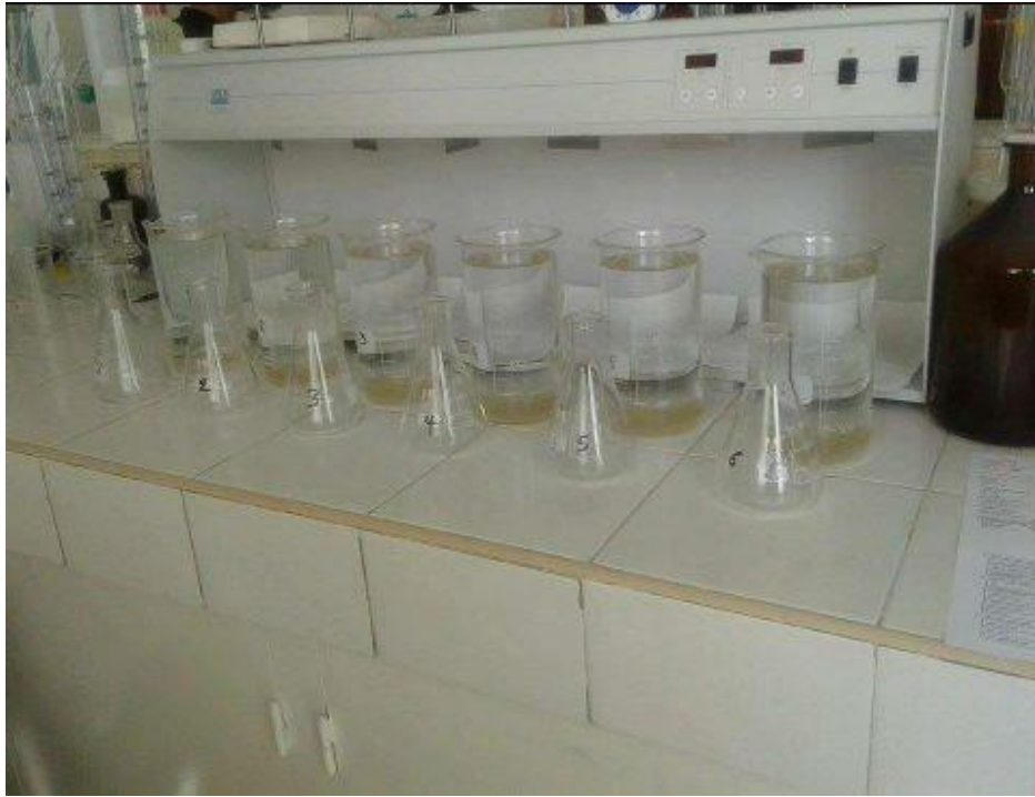
Figure13 :Essai de coagulation floculation « jar test »
