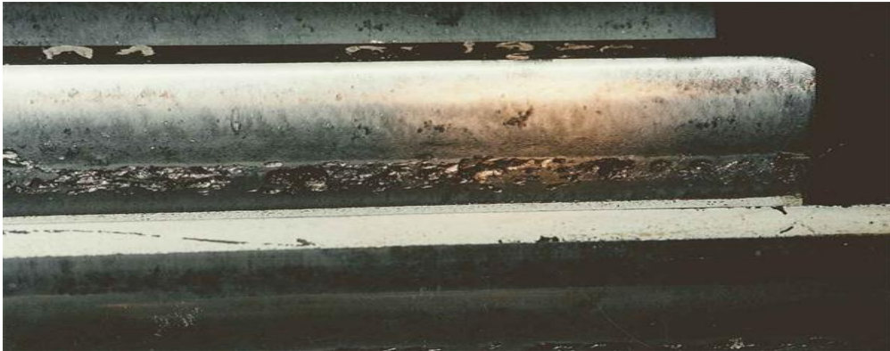
Figure 21: écaillage des dents d'engrenage
