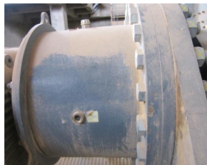
Figure 29 : réducteur de l'extracteur 212-TN1
