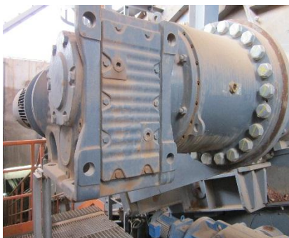
Figure 28 : réducteur de l'extracteur 212-TN3
