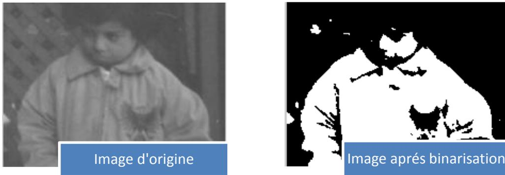
Figure 1. 7– Application de la méthode Otsu pour une image niveau de gris.
