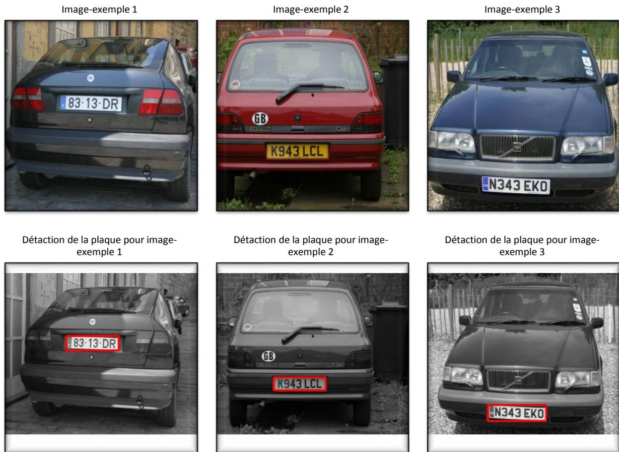
*Figure 1. 12– Exemples de Détection des plaques d'immatriculation.*
