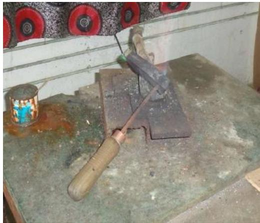
**Figure 8 : Soudure avec un chalumeau.**
