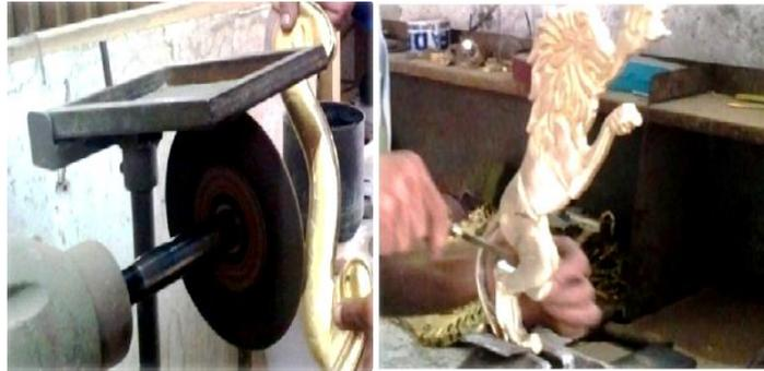
**Figure7 : Limage avec machine et manuelle**
