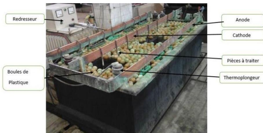
**Figure 18 : Bain de nickelage**
