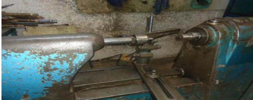
**Figure 5 : appareil de repoussage**
