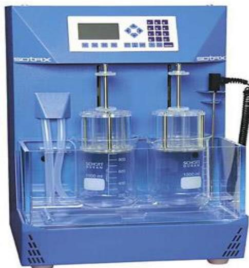
**Figure.7 :** *Appareil de désagrégation*
