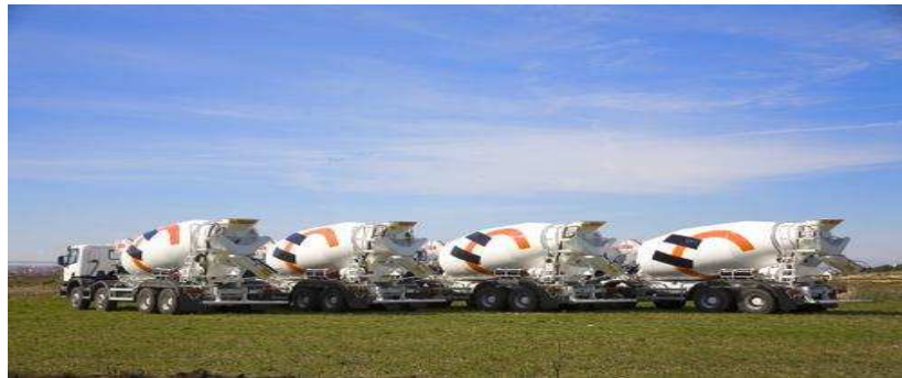
Figure 5 : Camions à bétonnières portées (toupie)
