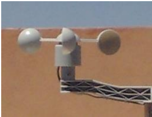
Figure 41: Anémomètre à coupelles GRLEX003
