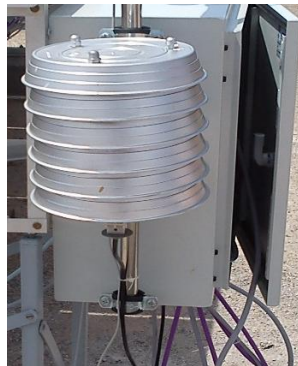
Figure 38: Capteur de mesure de la température ambiante
