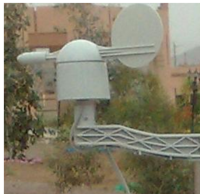
Figure 40: Girouette à potentiomètre
