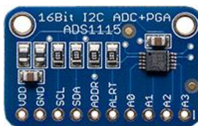
Figure 47: Convertisseur ADC 16 bit utilisé dans la station
