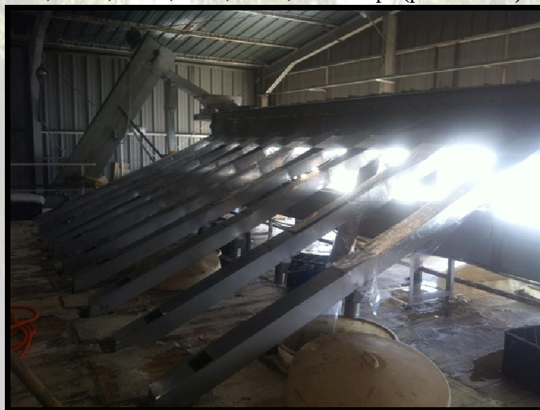
Figure 6 : Calibrage des olives par des câbles divergents
