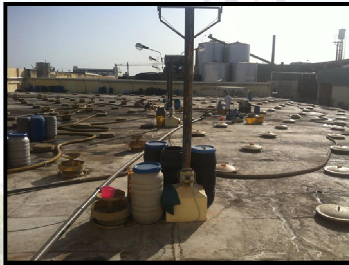
Figure 5 : La fermentation des olives dans les citernes sous-terraines
