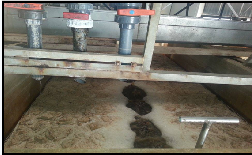
Figure 10 : Oxydation des olives en barbotant avec l'aire
