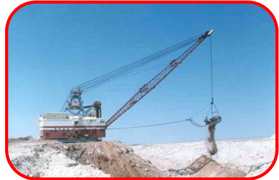
Figure 7 : Décapage par dragline M8400
