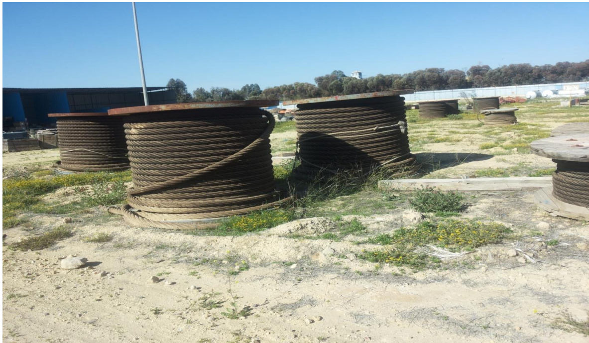
Figure 45: Dépôt des câbles de levage
