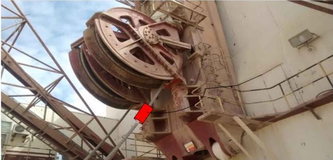
Figure 65: Emplacement de système de lubrification sur la machine
