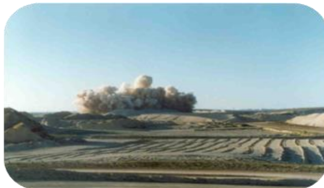
Figure 5: Opération du sautage
