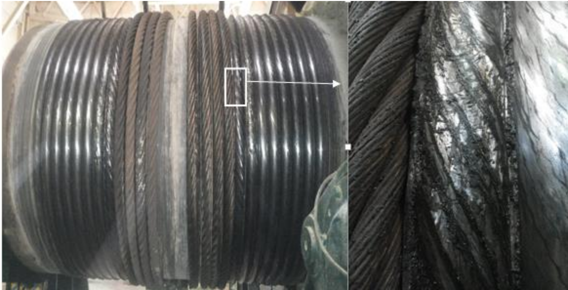
Figure 42: L'usure sur les gorges de treuil
