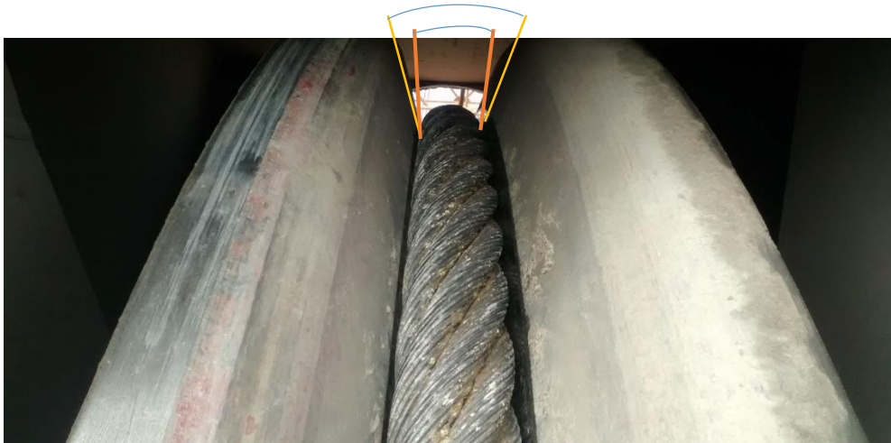
Figure 47: Usure de la poulie de renvoi
