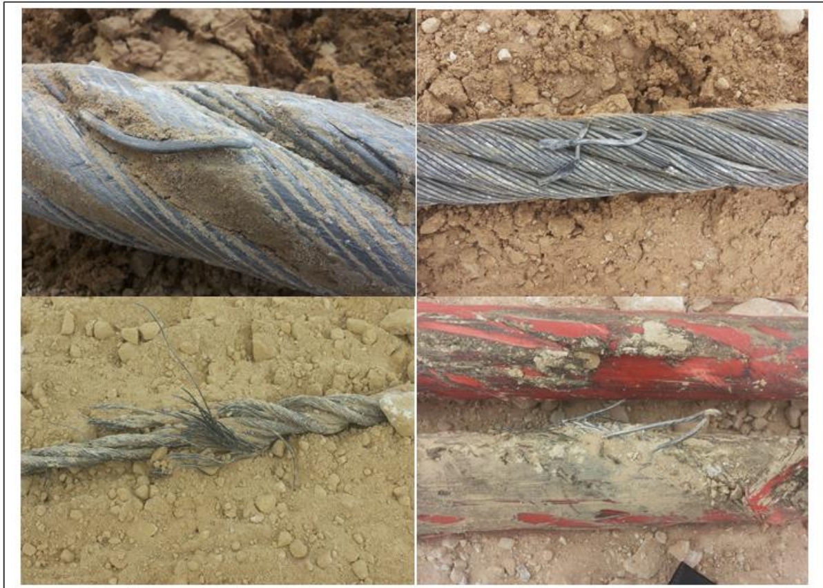
Figure 36: Différents types de casse des brins
