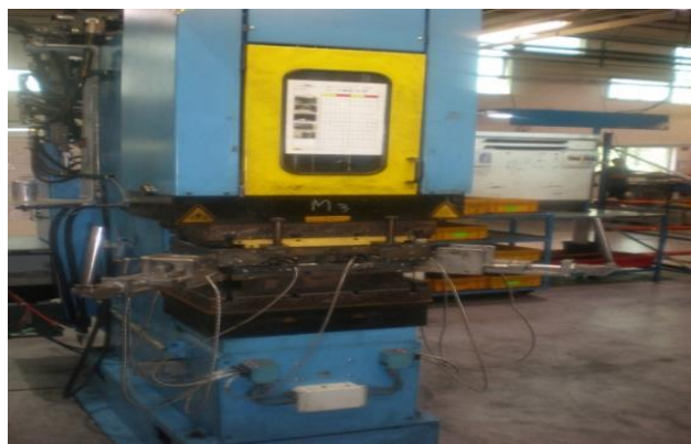
Figure 13 : machine presse d'injection
