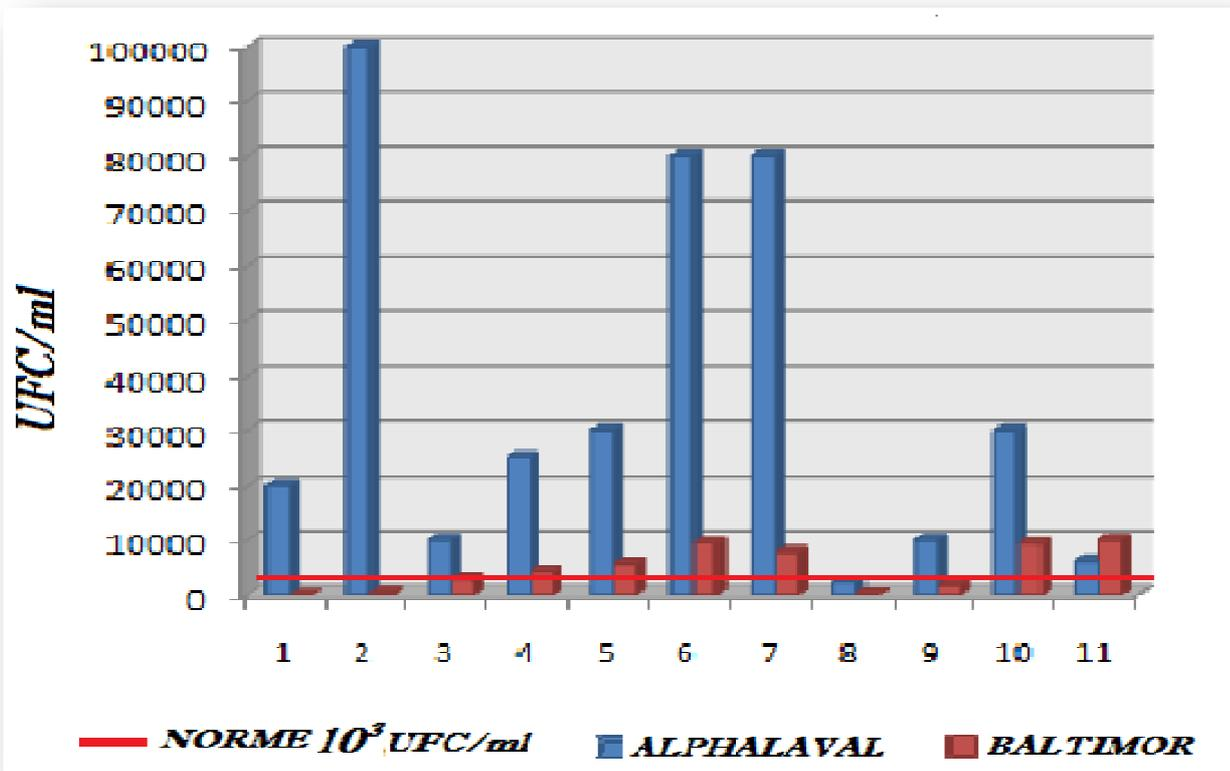
Figure n°1 : Evaluation de la charge en bactéries totales dans les eaux des tours ALPHALAVAL et dans celle de BALTIMOR
