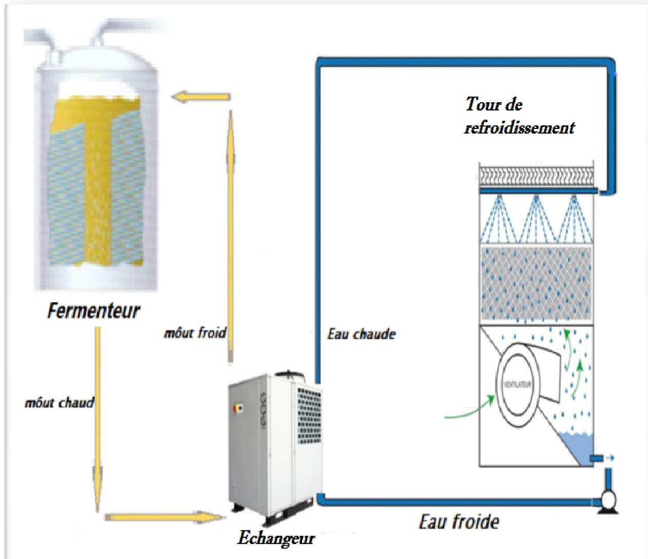
Schéma d'une tour de refroidissement et un échangeur et une tour de refroidissement
