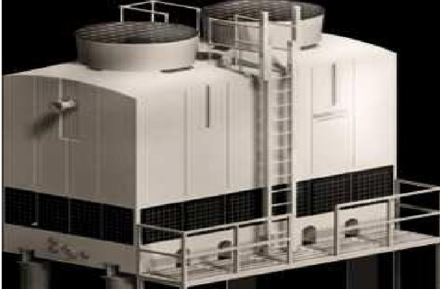
**Les tours de refroidissement** sont des dispositifs qui ont pour fonction d'évacuer vers le milieu extérieur la chaleur issue de systèmes de [refroidissement](#) (climatisation ou [procédé industriel](#)) en pulvérisant de l'eau chaude dans un flux d'air. Cette eau tombe par gravitation à l'intérieur d'un flux d'air frais remontant dans la tour. Cette circulation d'air permet de refroidir l'eau. (2)
