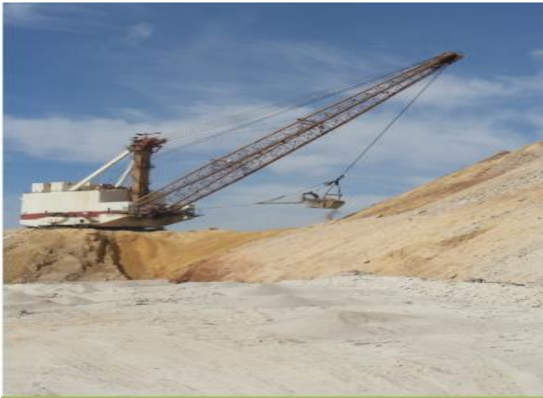
Figures5 : Opération de décapage par la dragline 8400
