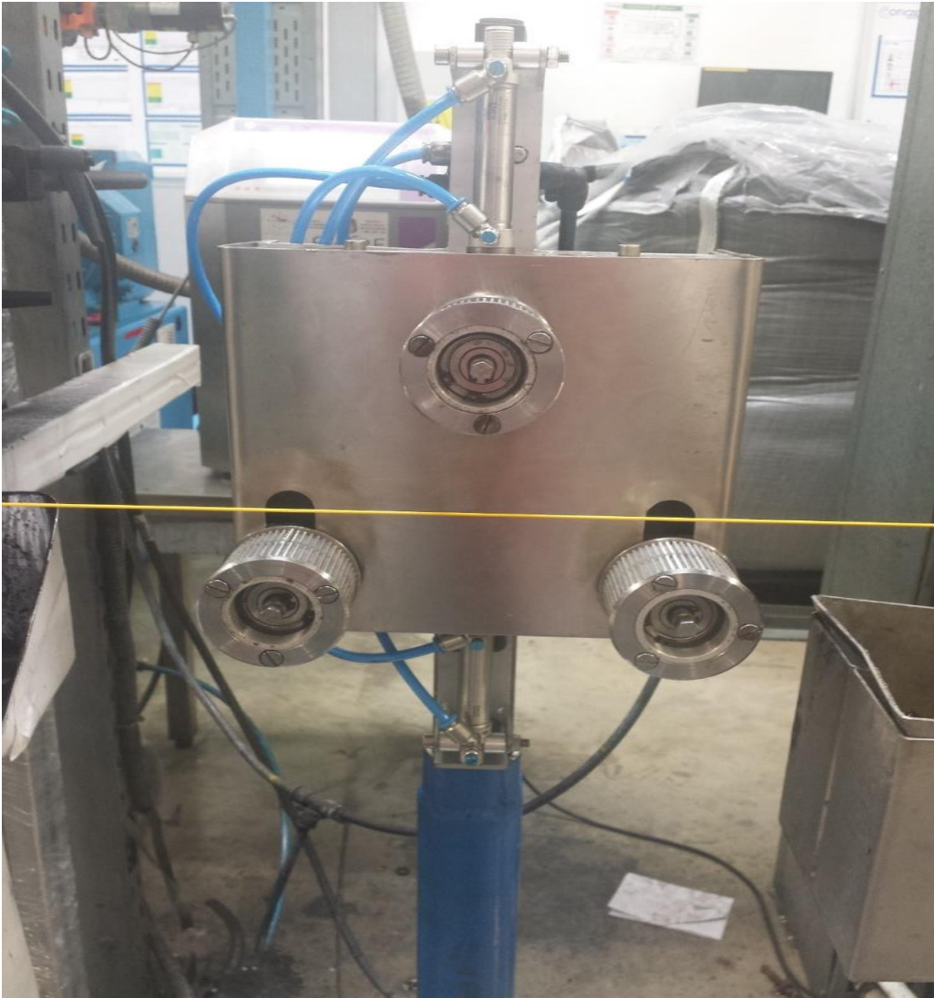
Figure 34: image du nouveau grattoir réalisé sur terrain
