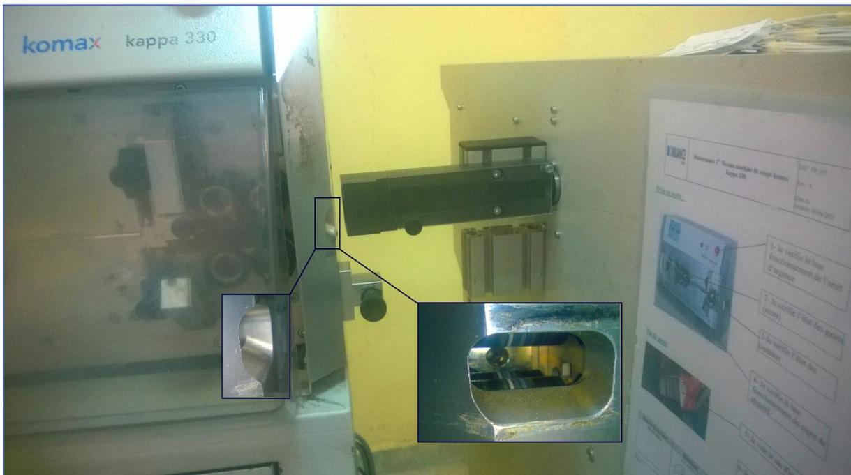
**Figure 43: La tige de guidage entre la machine de coupe et l'enrouleur**
