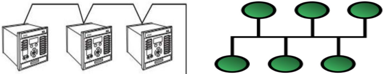
Figure N°28 : Exemple de topologie bus, utilisé pour relier les relais numérique.
