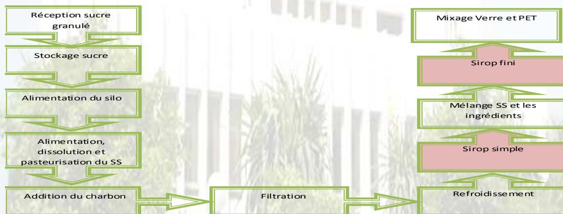
**Schéma de préparation du sirop simple et sirop fini**
