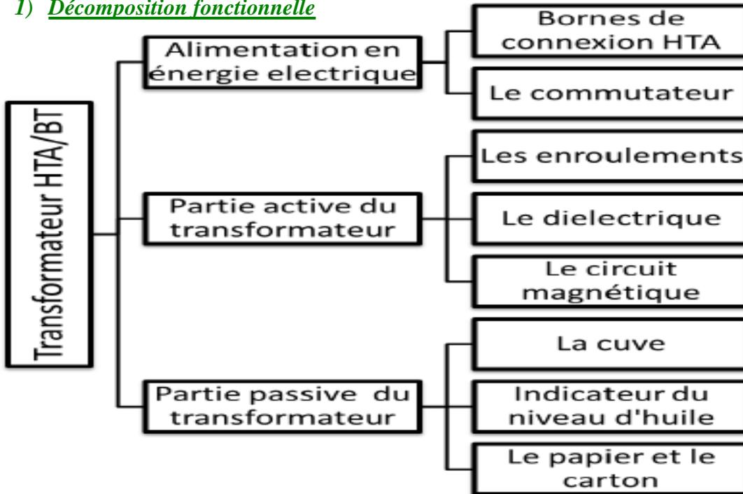
Figure 4.4 : Décomposition fonctionnelle du transformateur HTA/ BT
