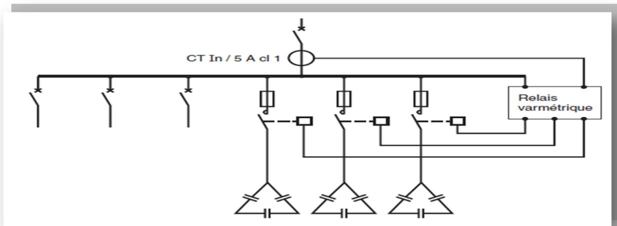
Figure 5.5: Principe de la compensation automatique
