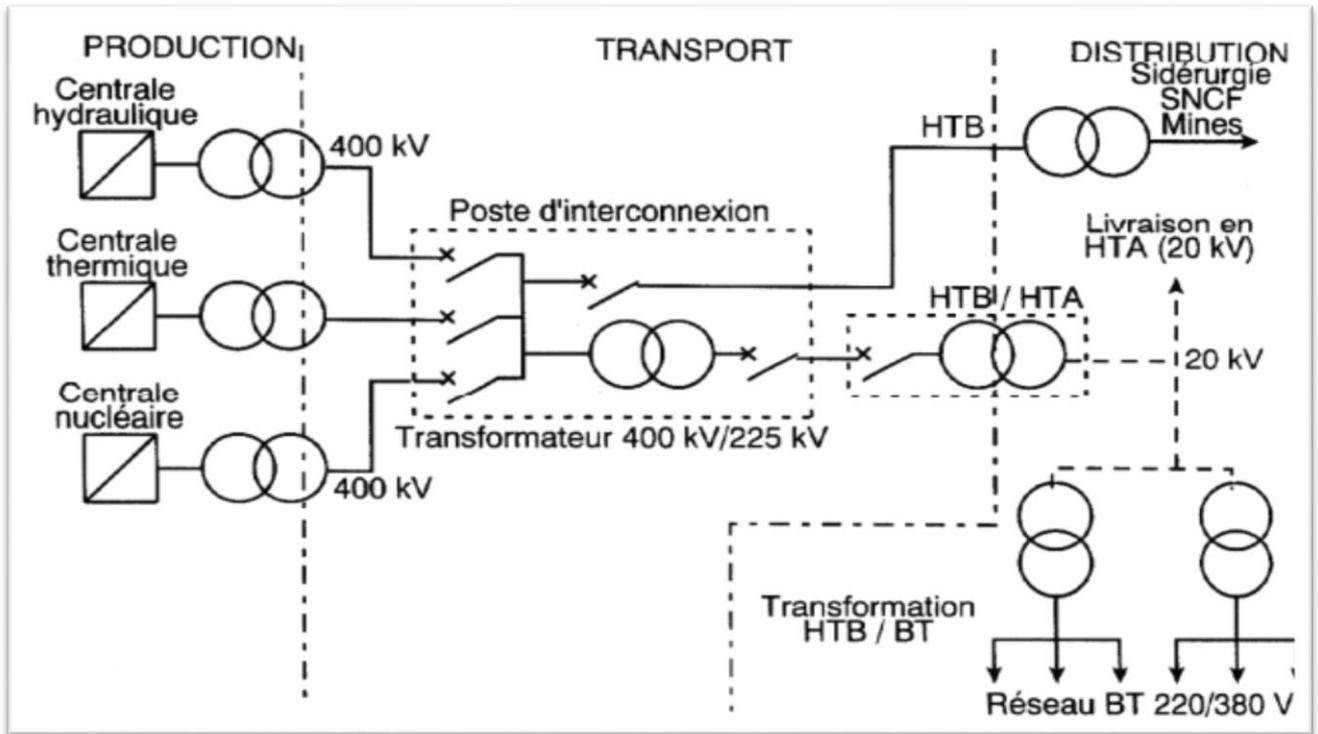
Figure 2.1 : structure d'un réseau de distribution
