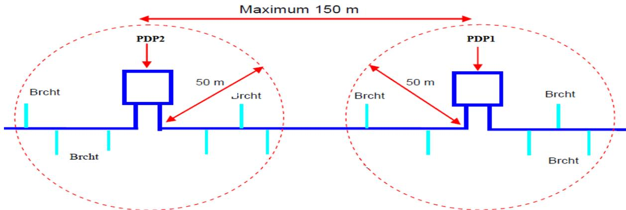
Figure 5.12 : La distance maximale en deux PDP
