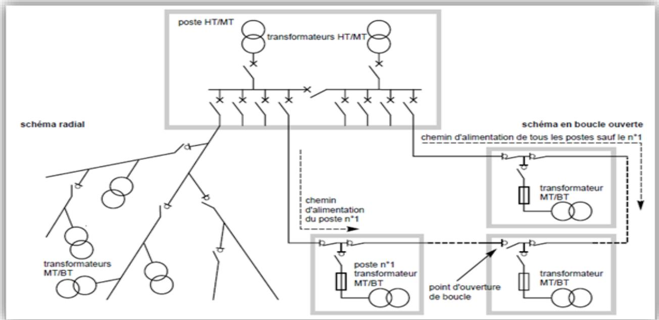
Figure 2.2 : Schéma radial
