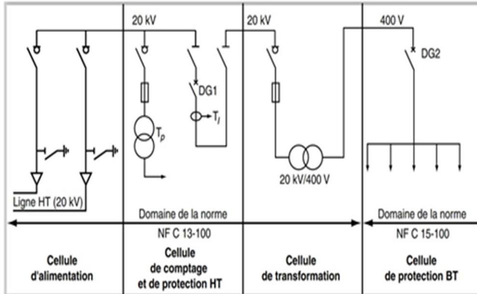
Figure 3.6 : Type et emplacement des cellules préfabriquées
