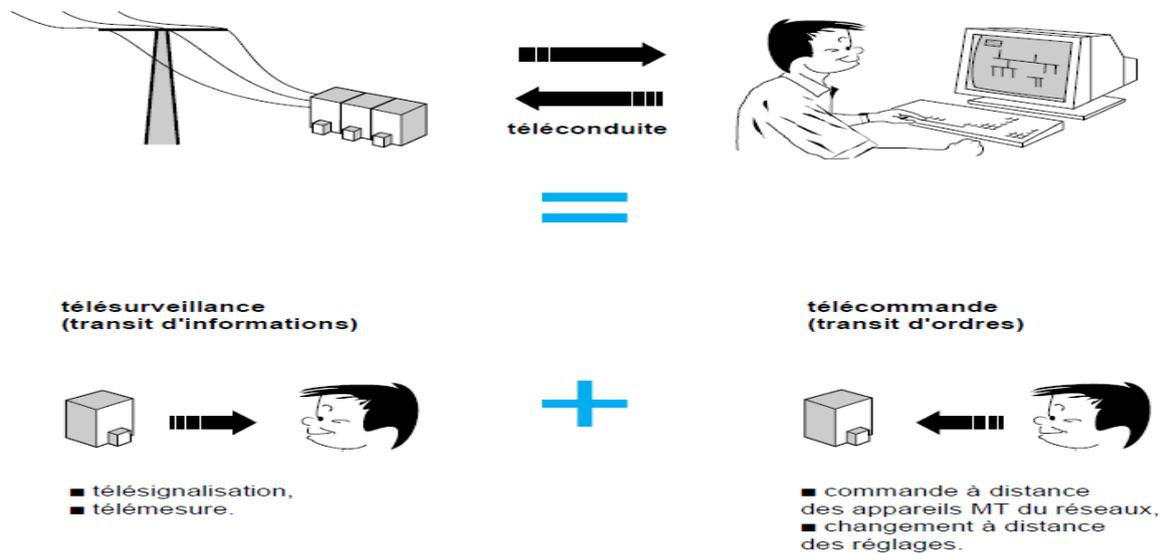
Figure 3.18: Principe de la télé-conduite du réseau électrique
