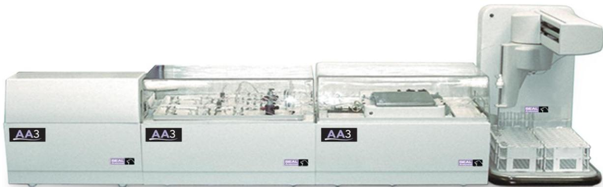
L'Analyse Flux Continu (CFA) permet d'automatiser intégralement les techniques analytiques complexes comme : préparation et traitement d'échantillons, dilutions, ajout de réactifs, mélange, dialyse, distillations, incubations et extraction liquide-liquide. On utilise la photométrie pour mesurer l'absorbance des échantillons et en déterminer leur concentration.
