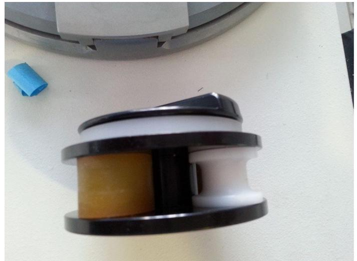
3- démontage des trois galets de la pompe à l'aide d'un marteau et un axe de diamètre 5mm.
