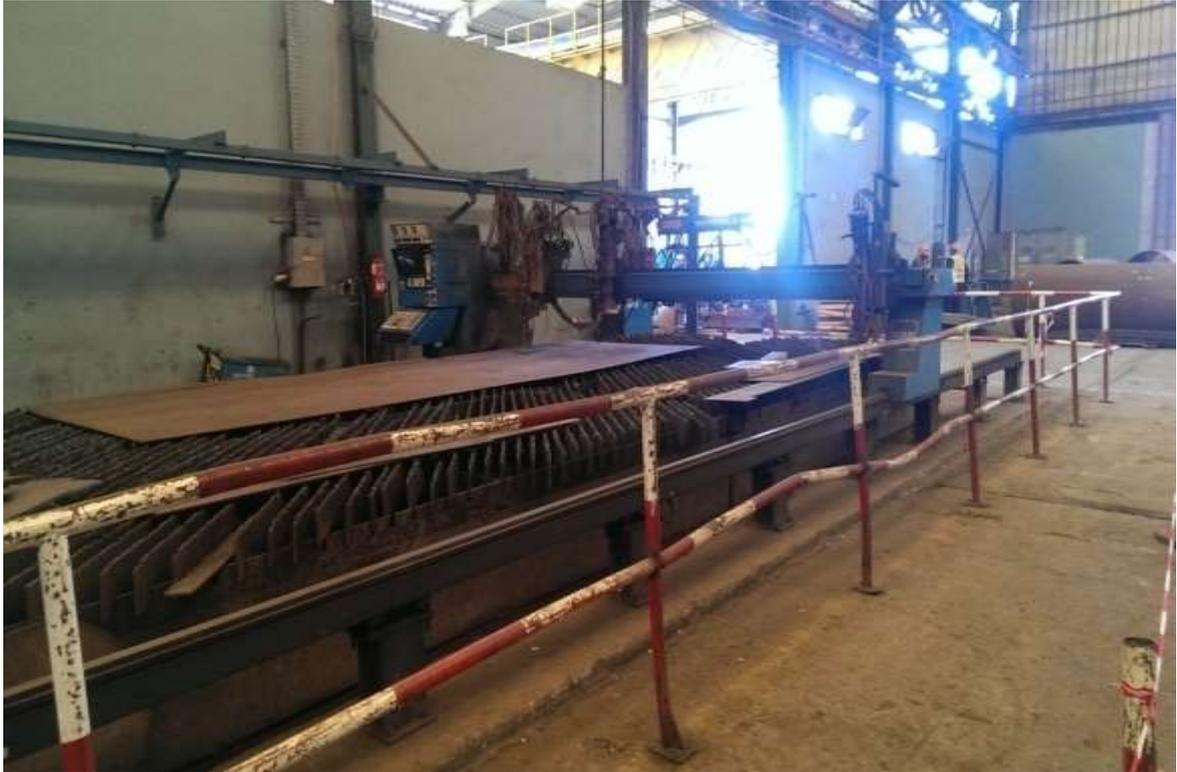
Figure 8: Machine oxycoupeuse STROC
