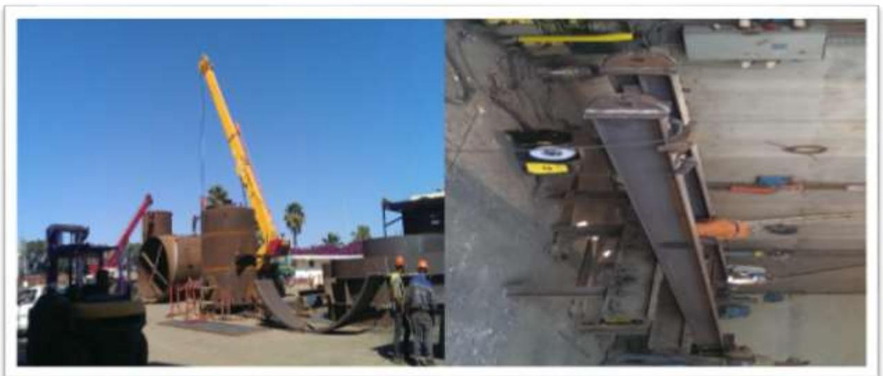
Figure 13: Assemblage de citerne et assemblage de chaudronnerie
