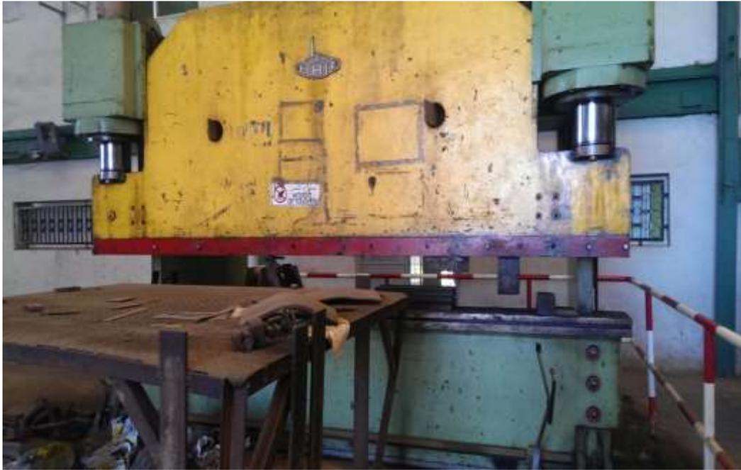
Figure 9: Plieuse hydraulique STROC
