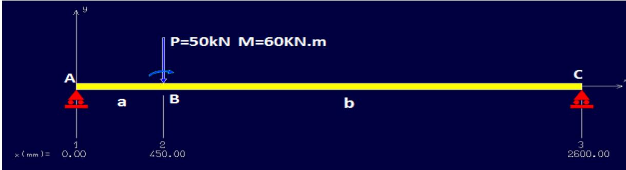
Figure 25: Modélisation 2D de la deuxième partie de BEAM ROTATOR
