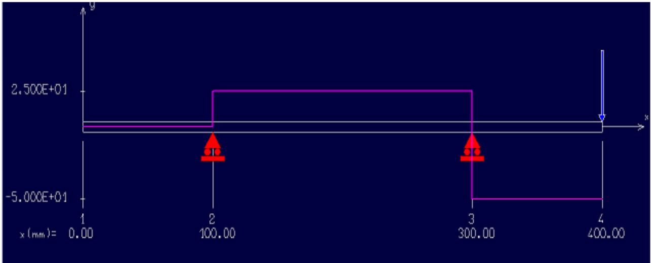
Figure 39: Représentation en modèle 2D de l'arbre et des paliers
