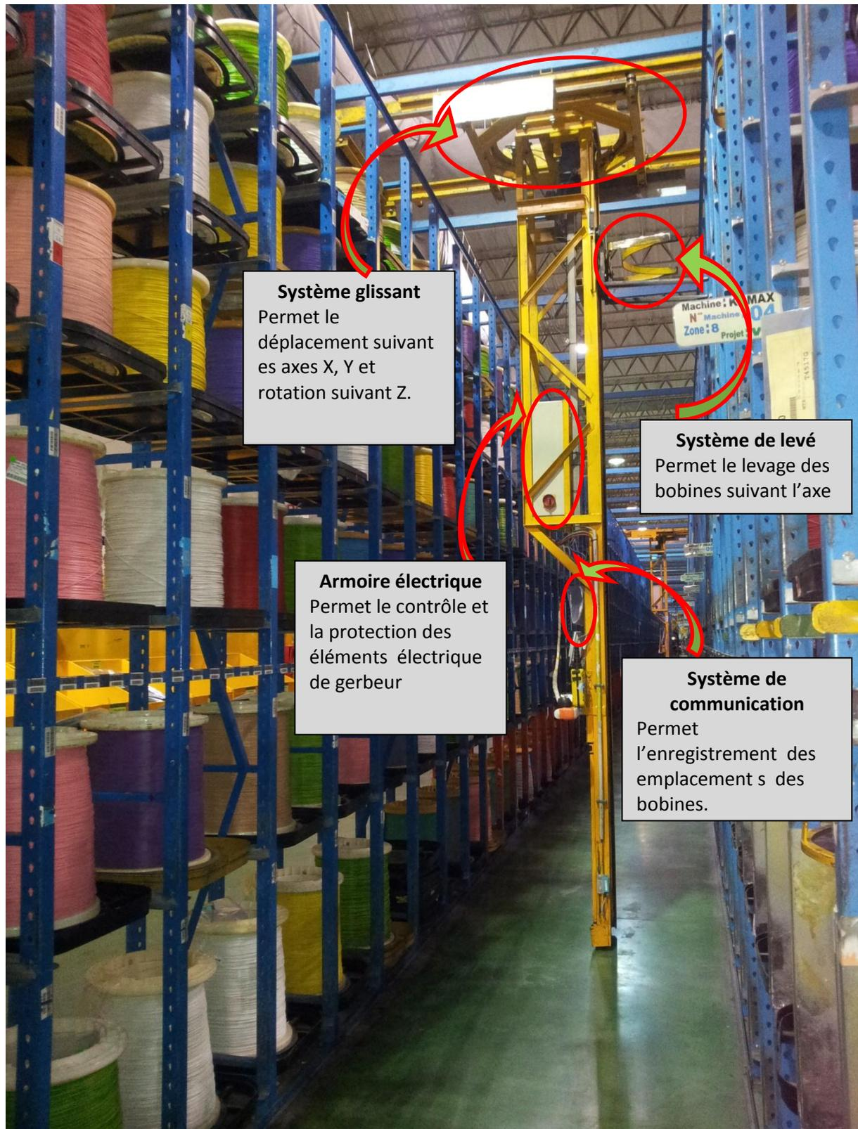
*Fig11' : constituant d'un gerbeur manuel*
