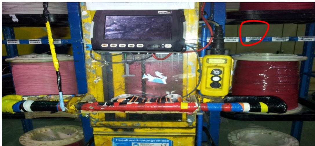
*fig14: adresse emplacement bobine déchirés*
