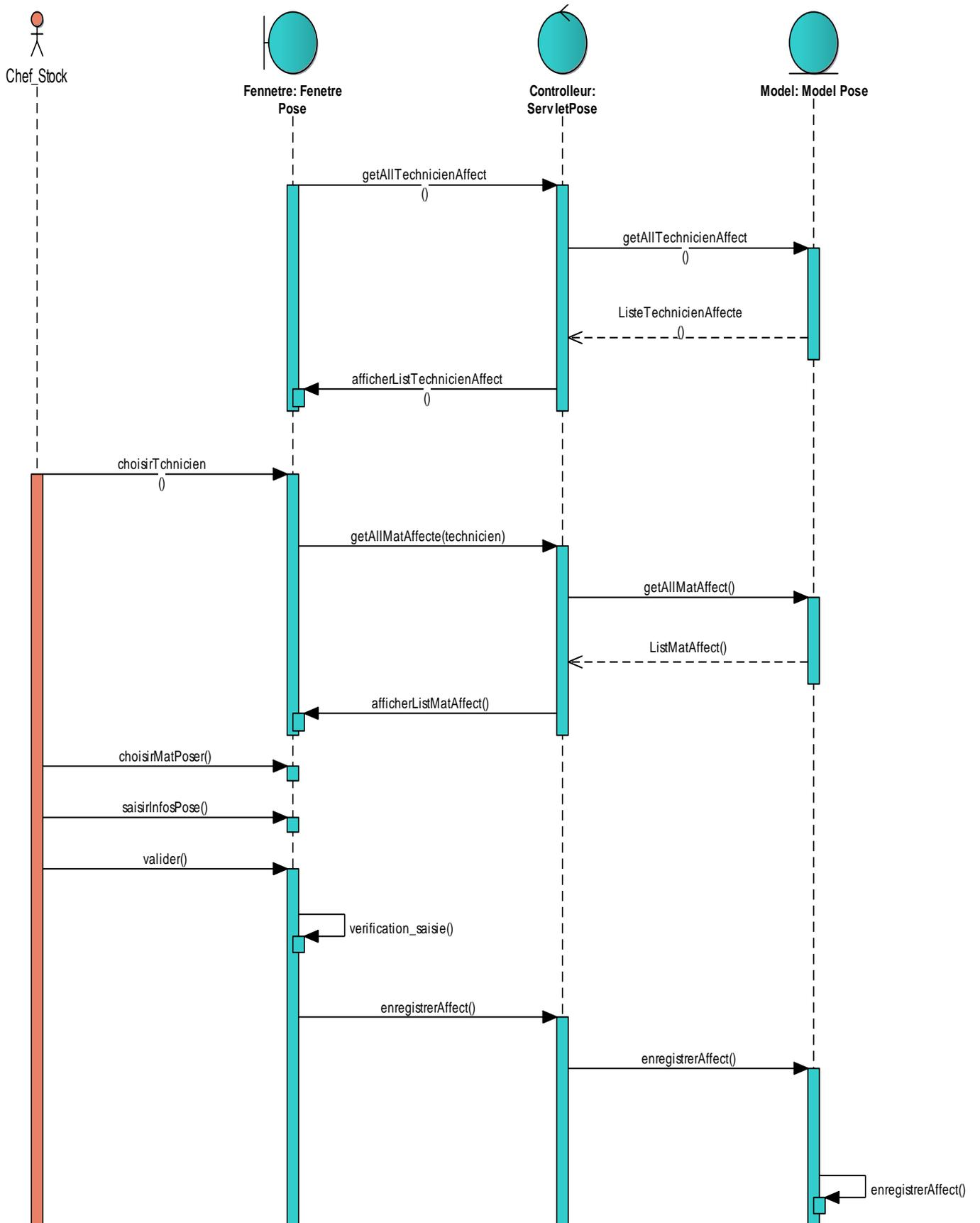
FIGURE 16 : DIAGRAMME DE SEQUENCE DE LA POSE DES COMPTEURS
