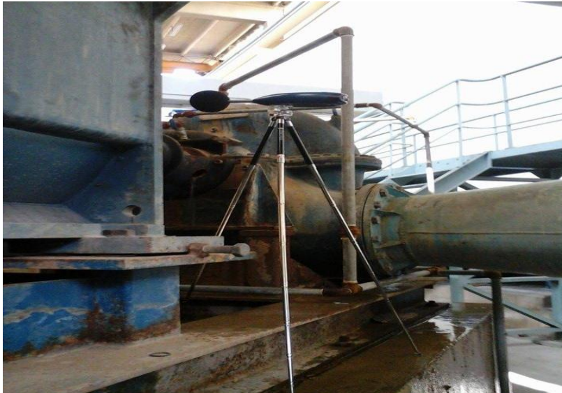
Figure 32 : L'emplacement du sonomètre pour mesurer le bruit émis.
