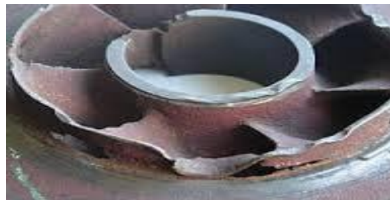
Figure 30 : Pompe centrifuge détruite par la cavitation
