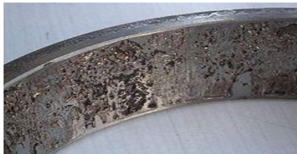
Figure 27 : Écaillage sévère sur une bague extérieure de roulement.
