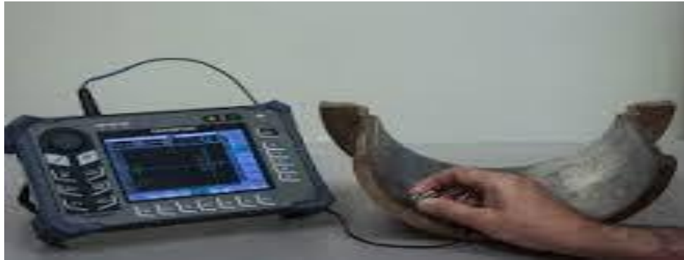
Figure 2.8: Contrôle non destructif d'un matériel
