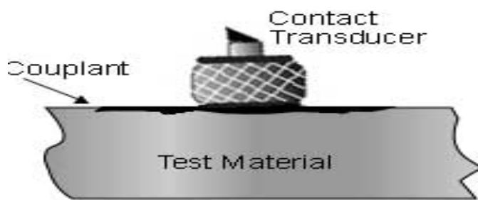
Figure 3.6: Couplage d'un transducteur par contact
